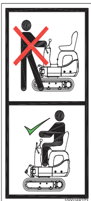
Fig. 38: Utiliser le levier de sécurité
