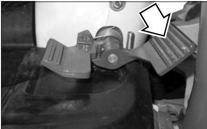
Fig. 117: Actionner le mécanisme de pivotement
