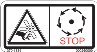
Fig. 24: Ventilateur dans le compartiment-moteur
