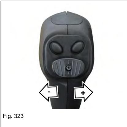
4. Réglage de la vitesse pendant la conduite. La machine peut également commencer le déplacement avec les interrupteurs (-) et (+).
