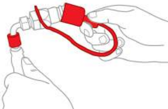
Figure: Bouchon et symboles sur les fiches hydrauliques.
