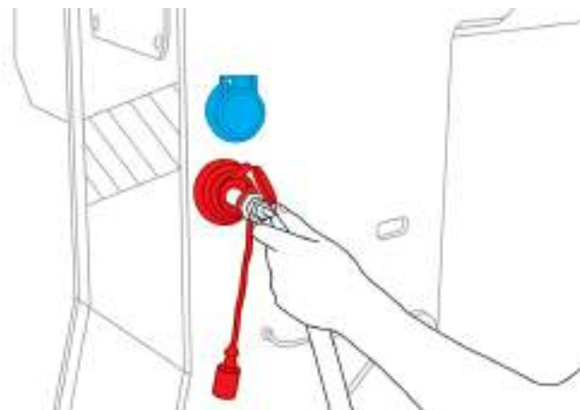
Figure: Prises hydrauliques sur tête de flèche
