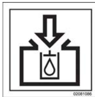
Remplissage du réservoir d'huile hydraulique
