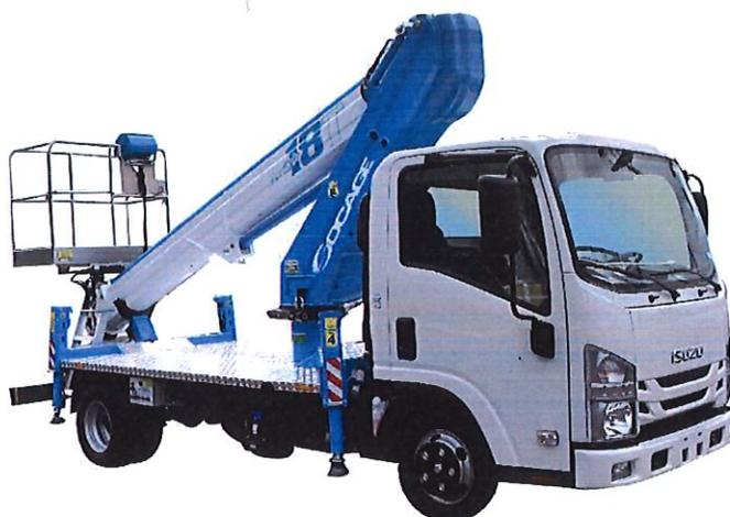
La forste **18T SPEED** se distingue par sa combinaison parfaite entre ses dimensions compactes, son faible poids et ses excellentes performances avec le système de stabilisation automatique **SOCAGE SPEED H+H**.
