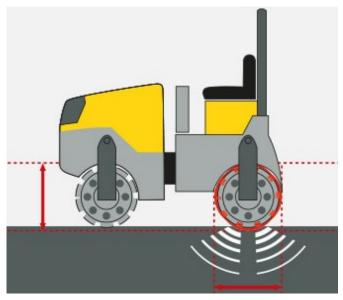
Compacte parfaitement même l'asphalte à basse température. Convient parfaitement au compactage des joints (chauds ou froids). Fonctionnement sans difficulté sur les ponts.
